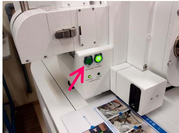
(8) 試料交換室から試料載せ台を取り外す。
