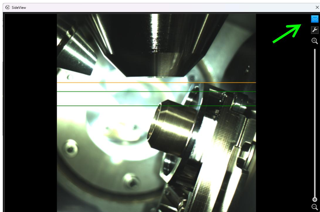
(3) カメラ画像をモニターしながら、検出器の詳細設定のダイアログを選択し、【Retract】を押す。EBSD 検出器が“完全に”引き出されるまで待機する。
