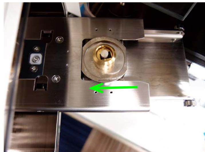
1-5. 【EVAC】ボタンを3秒間押し続け、試料交換室を真空排気する。
