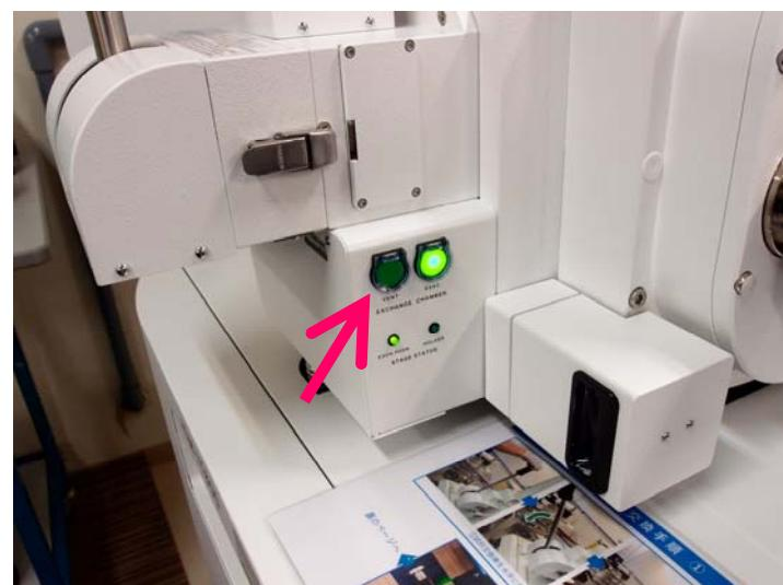
1-4. 試料交換室に試料載せ台を取り付け、ドアを閉める。
