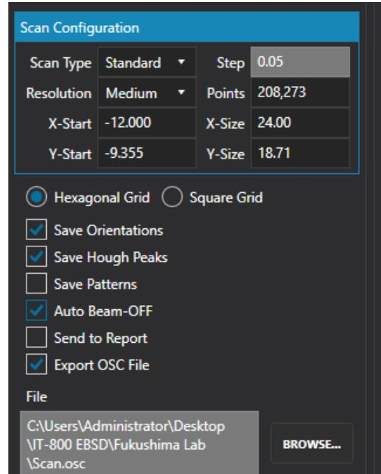
(5) 【Collect】を押して、測定条件を開始する。
