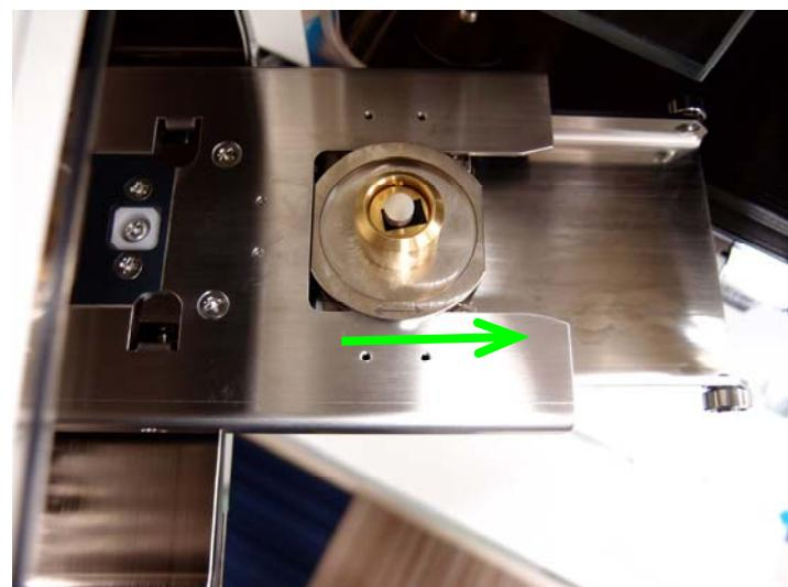
(9-1) サンプル交換の場合は、試料載せ台に次のサンプルを取り付け、
